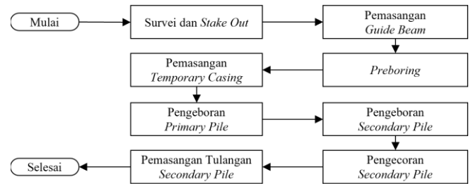
Gambar 4. Urutan pekerjaan secant pile .
