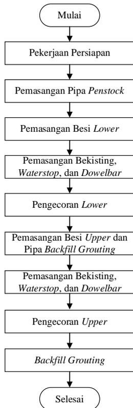
Gambar 7. Flowchart pekerjaan struktur.
