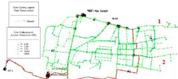
Gambar 9. Jaringan Dsistribusi Zona 1 pada Tahap Pengembangan II Setelah Perencanaan di Jam Puncak.
