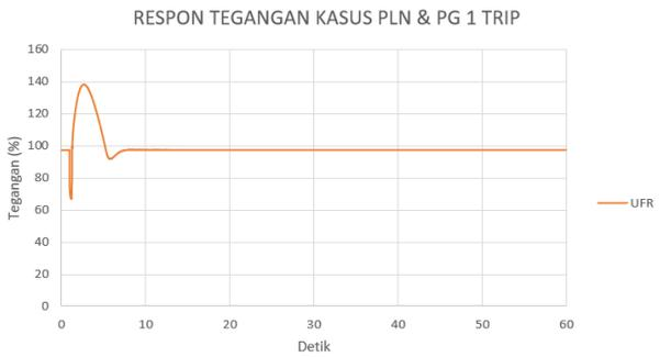
Gambar 14. Respon Tegangan Saat Pemadaman PLN dan Pembangkit Gas 1 Trip Dengan Mekanisme Pelepasan Beban Berbasis Frekuensi.
