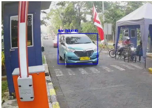
Gambar 1 Pengujian Deteksi Objek Pada Data Video CCTV
