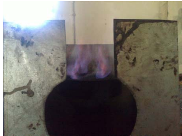
Gambar. 2. Visualisasi pada ukuran tempurung kelapa (0,8-12,6) cm^2 dengan AFR = 0,88 yang tepat.
