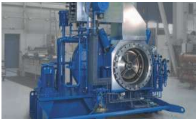
Figure.3. Siemens SST 060 Turbine
