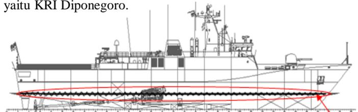
Gambar 4.1 Peletakkan kumparan (ditunjukkan panah) tampak samping kapal
