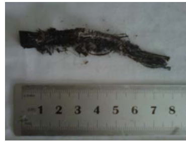
Gambar.1. Bambu Petung T= 300 °C Mulai Terbentuk Karbon Hitam
