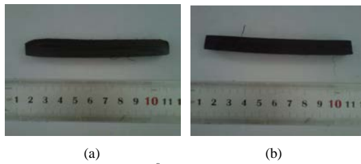
Gambar.2. (a) Bambu Petung T= 300 °C Tanpa Kulit (b) Bambu Petung T= 300 °C Dengan Kulit
