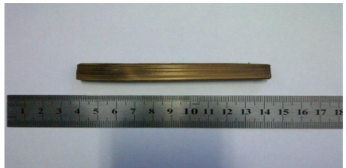
Gambar. 2. Bambu petung dengan radiasi gelombang mikro daya 800 watt selama 3 menit.
