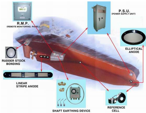
Gambar. 1. Komponen-komponen yang terdapat pada sistem ICCP
