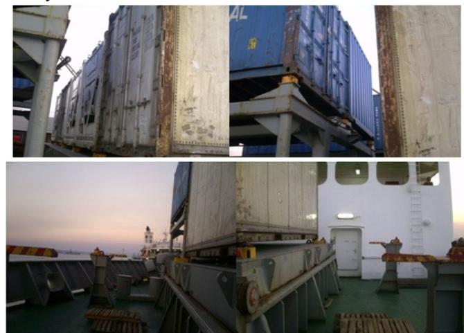
Gambar 6. Penempatan peti kemas di atas kapal 2 in 1
