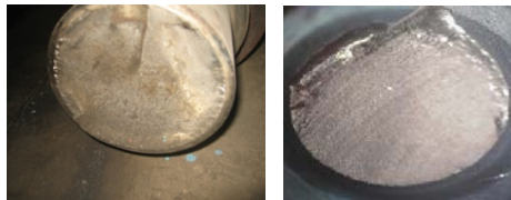
Gambar 1. Pola patahan yang terjadi pada wobbler bar
