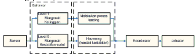
Gambar 3.3 Rancangan Behavior-based pada Quadcopter
