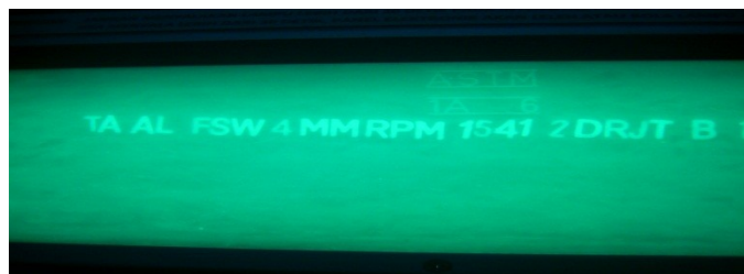
Gambar 7 Hasil uji radiografi menggunakan pin segitiga ( triangle )
