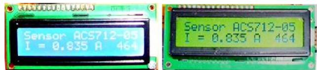
Gambar 16. Tampilan *display* pada *Transmitter* dan *Receiver*
