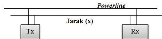
Gambar 15. Bentuk pengujian jarak pengiriman data melalui jala-jala.
