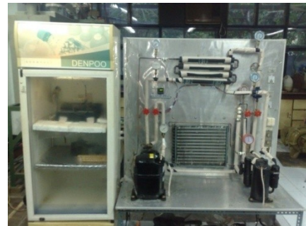
Gambar 7 Sistem refrigerasi cascade yang digunakan
