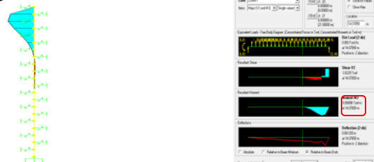
Gambar 11. Diagram momen akibat gaya lateral dan nilai z_f pada kedalaman 6,93 m hasil program bantu SAP 2000
