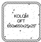
Gambar 6. Penampang kolom CFT Profil 650.650.25.25.
