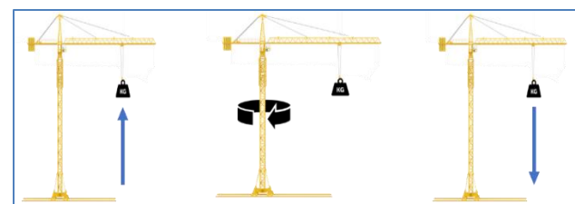
Gambar 7. Beban 1 Cycle pada Tower Crane Potain MD 900.
