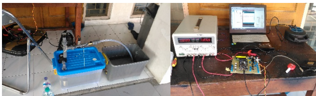
Gambar 10. Pengujian karakterisasi sensor water flow
