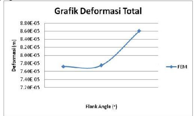
Gambar 9. Deformasi Total pada Variasi Sudut Mahkota.
