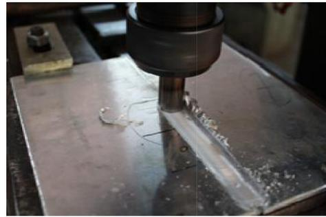
Gambar 2. Proses Pengelasan FSW
