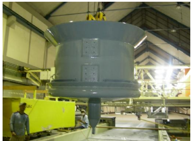
Gambar 1. Struktur keel terpasang pada buoy [2].
