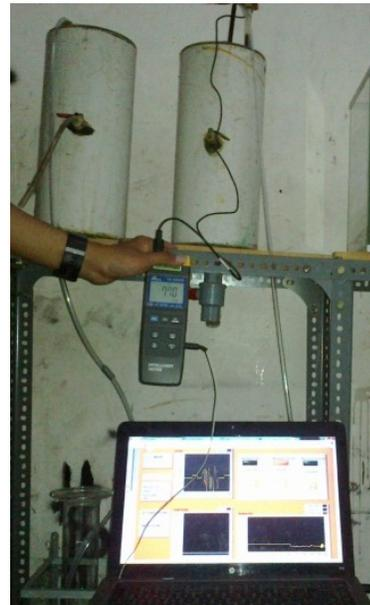
Gambar. 6. Implementasi Estimator Pengukuran pada Bioreaktor Secara Online
