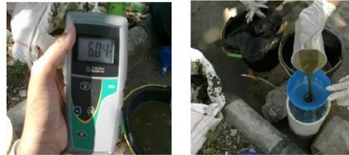
Gambar. 8. Nilai pH pada saat pengukuran dan pemasukan substrat
