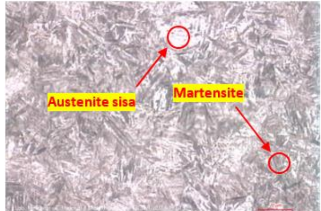
Gambar 3. Struktur mikro ASSAB 705 setelah water quench hardening (H).
