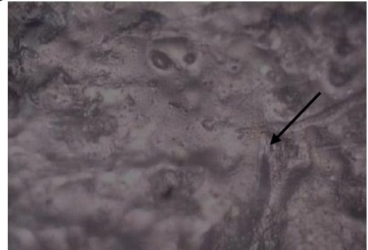
Gambar 8. Foto mikro spesimen 5% fiber dengan perbesaran 200x
