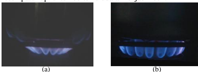
Gambar 11. Model api pada saat pengujian waktu pendidihan air (a) Kompor firewall 2.5 inci pada ketinggian 0 mm (b) Kompor firewall 3 inci pada ketinggian 5 mm
