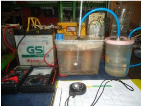
Gambar. 7. Rangkaian uji laju produksi gas HHO.
