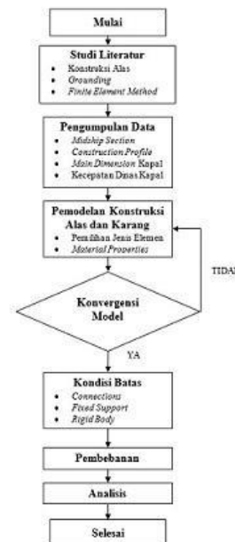
Gambar 11. Diagram alir pengerjaan penelitian. Untuk analisis struktur digunakan pendekatan finite element method .
