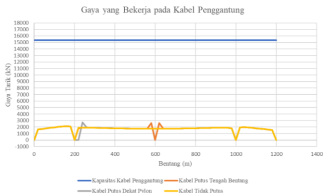
Gambar 19. Gaya yang Bekerja pada Kabel Penggantung
