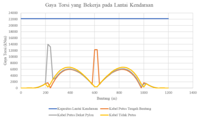
Gambar 21. Gaya Torsi yang Bekerja pada Lantai Kendaraan.
