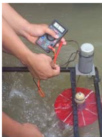
Gambar. 6. Pengukuran tegangan dan arus dari Generator DC.
