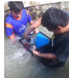
Gambar. 4. Pengukuran RPM turbin menggunakan tachometer digital.
