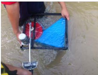
Gambar. 5. Pengukuran torsi turbin menggunakan torsimeter static.
