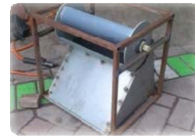
Gambar. 3. Penggabungan rotor turbin, rangka dan pemandu arah aliran.
