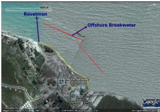
Gambar 11. Layout rencana *revetmen* dan *offshore Breakwater*
