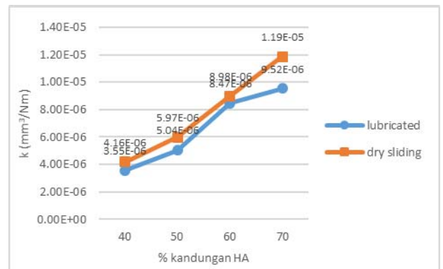
Gambar. 5. Hasil perhitungan laju keausan. Dry sliding adalah pengujian tanpa pelumasan dan lubricated adalah pengujian dengan pelumasan
