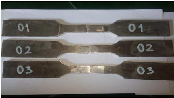
Gambar 5. Spesimen Non Heat Treatment Tensile Test Result.
