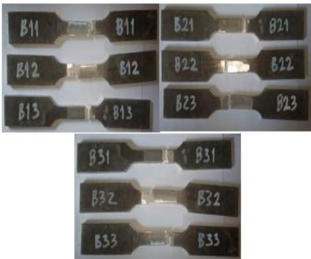
Gambar 7. Hasil uji tarik spesimen Aging 260°C.
