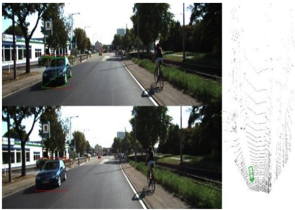
Gambar 15. Demonstrasi Stereo R-CNN. ( atas: bounding box 3D; bawah : klasifikasi & bounding box 2D; kanan: bird eye's view).
