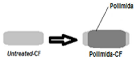
Gambar 3. Mekanisme sizing dengan poliimida.
