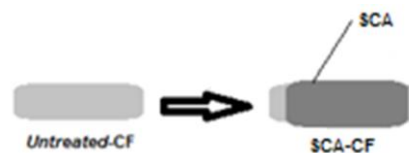
Gambar 2. Mekanisme sizing dengan silane coupling agent .
