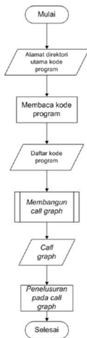
Gambar 1. Diagram Alir Proses Mendeteksi Unused Methods aplikasi yang sedang dikembangkan sehingga dapat dilakukan penanganan dengan lebih cepat.
