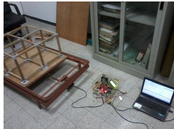
Gambar 4.6 Sistem Kontrol Meja Getar Gempa
