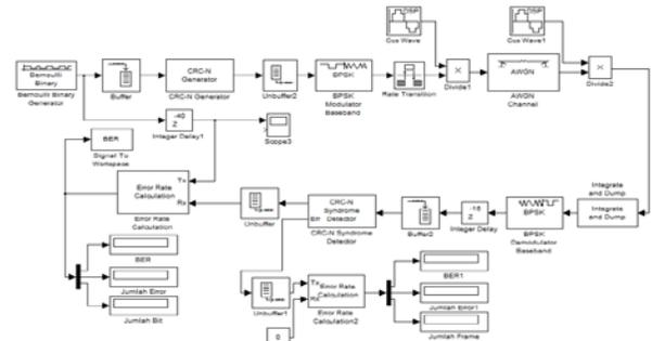
Gambar 6. Blok Diagram Simulasi Kode CRC Dengan Modulasi BPSK *passband* dan kanal AWGN
