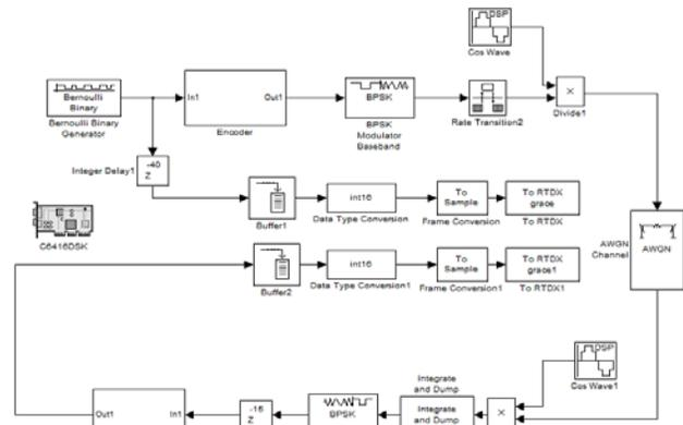
Gambar 7. Blok Implementasi Kode CRC Pada TMS320C6416T
