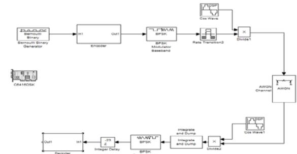
Gambar 8. Blok Diagram Utama Untuk Deteksi Error Per Frame
