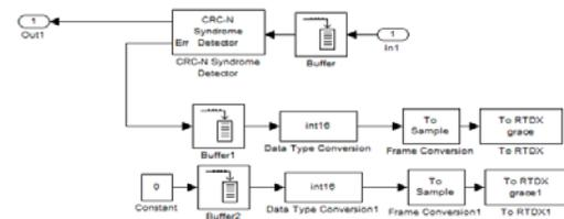
Gambar 9. Blok Diagram Pada Bagian Decoder CRC
