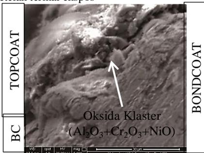
Gambar 6. Hasil pengujian SEM Penampang antara bondcoat dan topcoat
