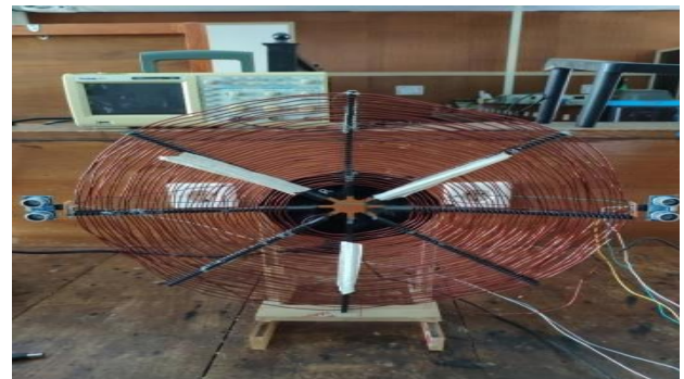
Gambar 5. Realisasi kumparan dengan ultrasonik.
