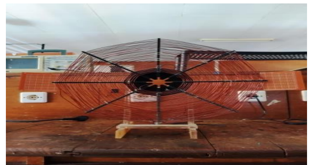
Gambar 6. Realisasi kumparan dengan penampang.
