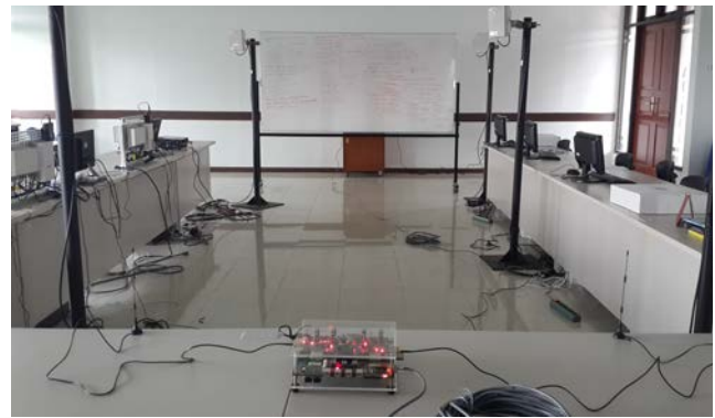
Gambar 9. Kondisi pengukuran Non-Line-of-Sight. Pada gambar dapat diamati posisi dari obstacle yang menghalangi kedua antenna penerima. Penempatan ini memberikan penurunan kurva BER terhadap daya pancar dan dapat diamati pada gambar 8
