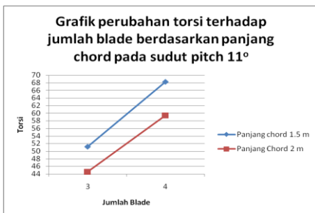
Gambar 3.4 Grafik perubahan torsi terhadap jumlah blade berdasarkan panjang chord pada sudut pitch 11°.
