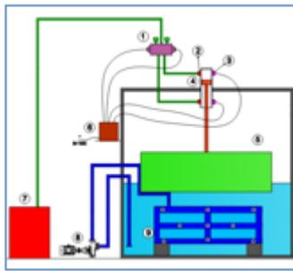
Gambar 1. Konfigurasi Wave Maker
