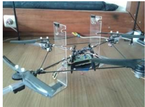
Gambar. 10. Quadrotor dengan penyangga
