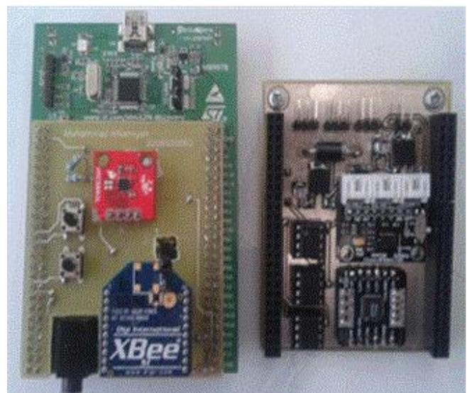
Gambar. 3. Realisasi *Hardware* Sistem *IMU*.
