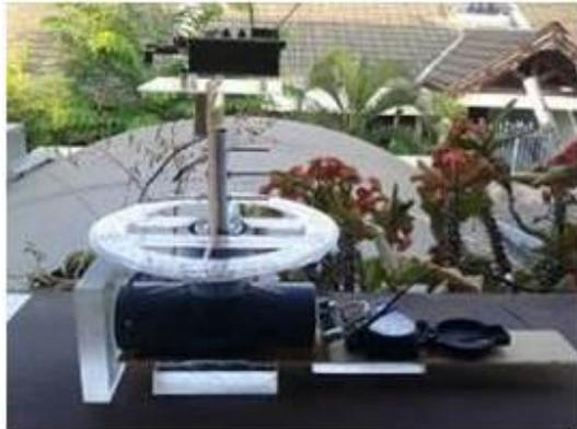
Gambar 6. Gimbal elektronik dalam pengujian sudut estimasi yaw.
