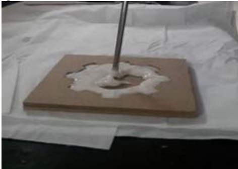
Gambar 5. Injeksi sampel silicone rubber/Chitosan pada cetakan gigi.
