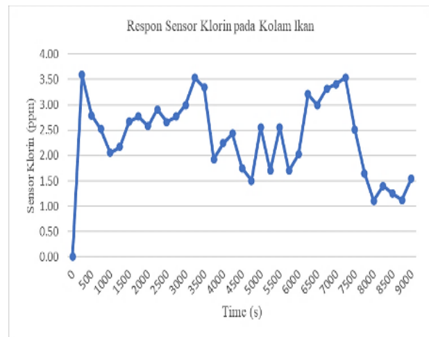
Gambar 22. Grafik respons sensor menggunakan kontrol PID pada kolam ikan nila.
