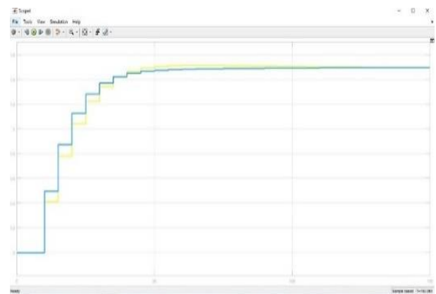
Gambar 19. Grafik kontrol PID orde tiga.
