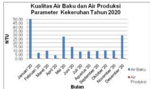
Gambar 2. Skema Eksperimen alat penelitian Grafik Perbandingan Kualitas Air Baku dan Air Produksi Parameter Kekeruhan.
