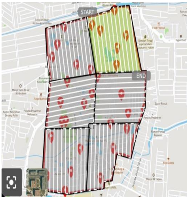
Gambar 3. Jalur terbang UAV DJI Phantom 4 Pro pada perangkat lunak Pix4DCapture.
